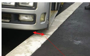
緑石への進入時に、車体が歩道側にオーバーハングするため、構造物までの距離が必要となる
