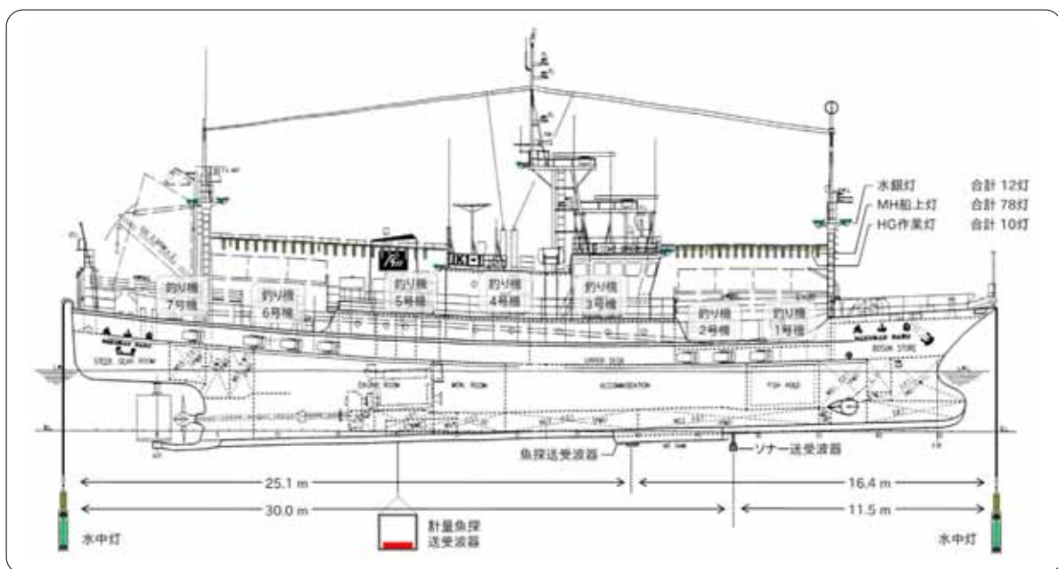
図1 調査船白山丸の船上灯、水中灯、釣り機および音響機器送受波器的配置
