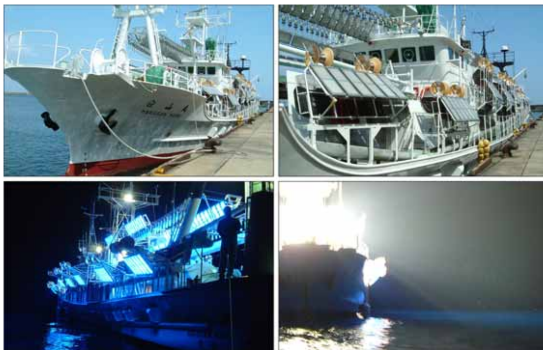
図1 調査船白山丸のLED灯設置状況
