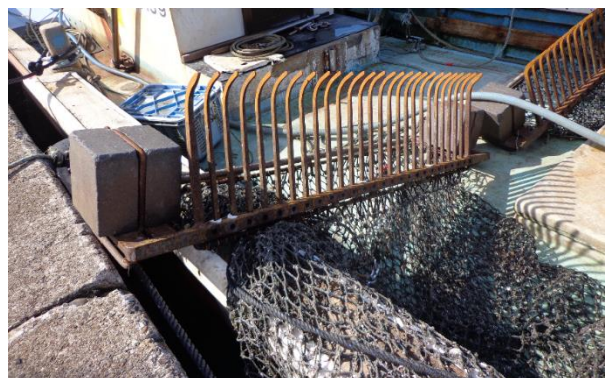
写真 貝桁網操業で使用する漁具 長いツメで海底を掘り起こすようにして貝を獲る。
