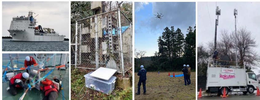
船上基地局 (NTTドコモ・KDDI) 可搬型衛星アンテナスターリンク (KDDI) 有線給電ドローン (ソフトバンク) 車載型基地局 (楽天モバイル)
