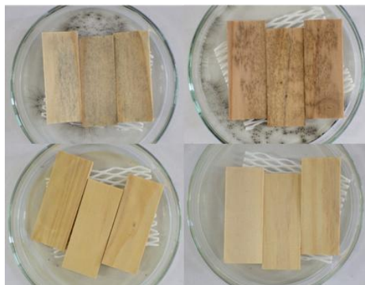
写真-1. A. pullulans 接種後 4 週間培養した試験体
