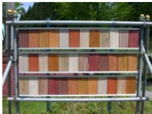
写真：曝露開始 6 ヶ月後の状況
