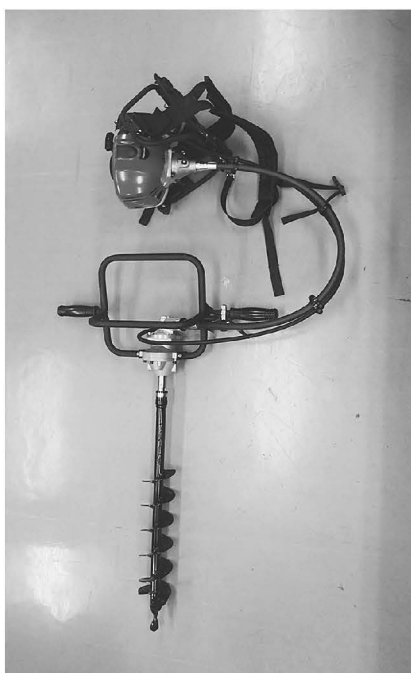
写真-1 苗木植栽機
