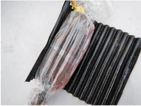
写真-2 ビニールを巻いた上からMスターコンテナを縛りつける手法
