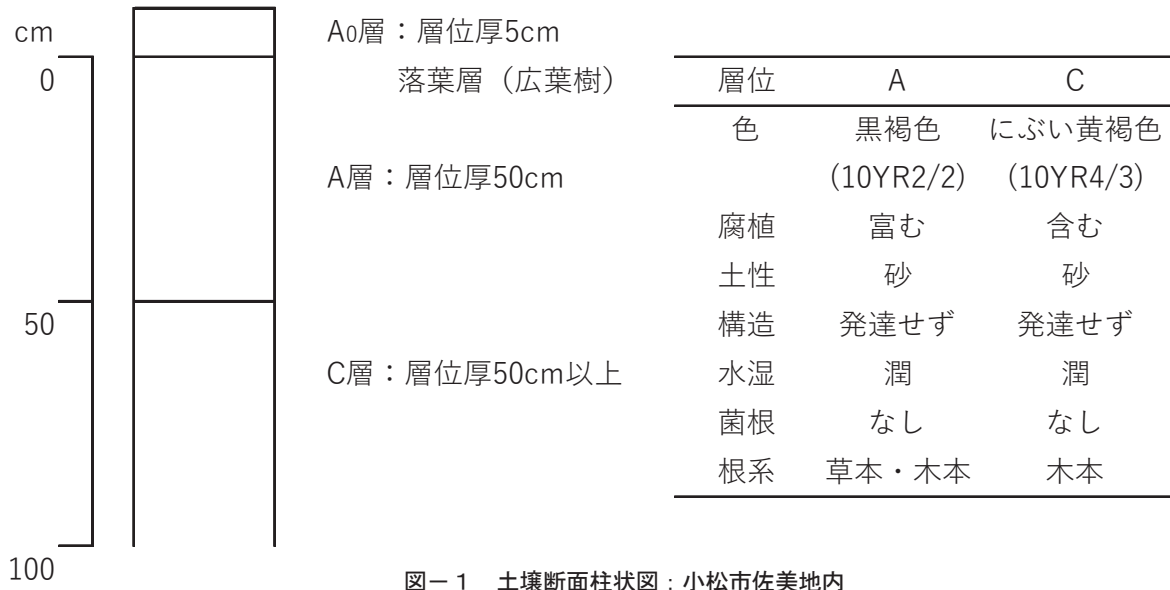
図-1 土壤断面柱状図：小松市佐美地内
