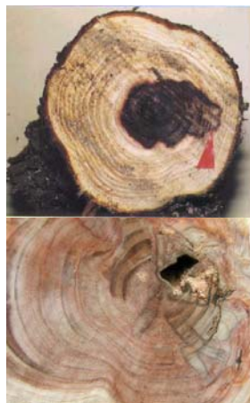
写真－8. (上) スギノアカネトラカミキリの幼虫による食害
