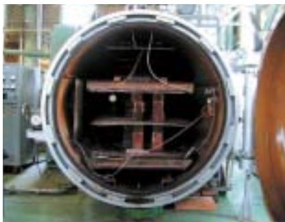
極板の間に乾燥させる木材を挟み込み、減圧（真空）下で高周波加熱を行いながら乾燥する方法です。
