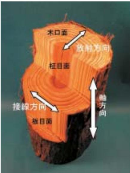
図2 スギ材の3断面3方向
