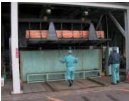
この乾燥方法は、棧積みした木材をパラフィンなどの油脂中に浸漬したまま100℃以上の温度で加熱する方法です。
