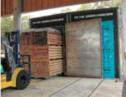
最近、急速に普及している乾燥方法です。一般的に、蒸気式乾燥法の中で100 以上の温度で乾燥する方法を高温乾燥と呼んでいます。乾燥温度を高くすると乾燥時間を短くすることができます。
