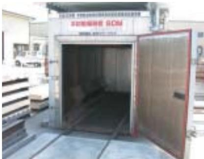
現在最も多く普及している乾燥方法で、乾燥温度は約50～90℃が一般的です。温度、湿度、空気循環により乾燥を進めます。
