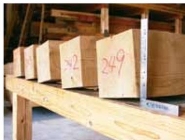
写真-12. 能登ヒバのねじれ量の計測状況
