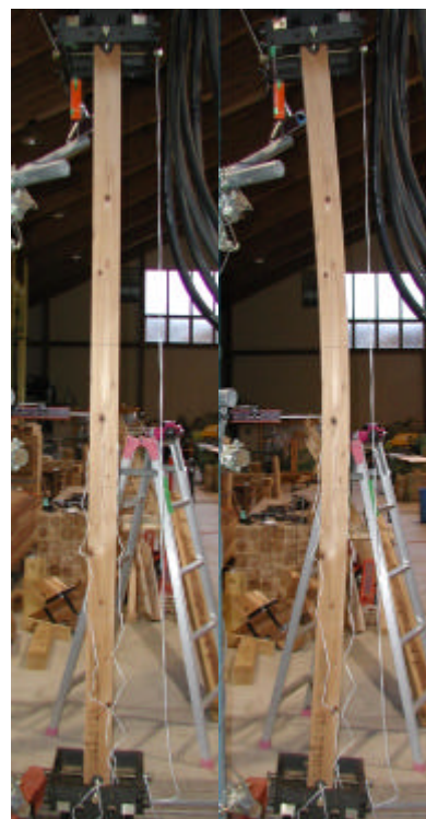
試験前 試験後 写真 柱の縦圧縮試験
