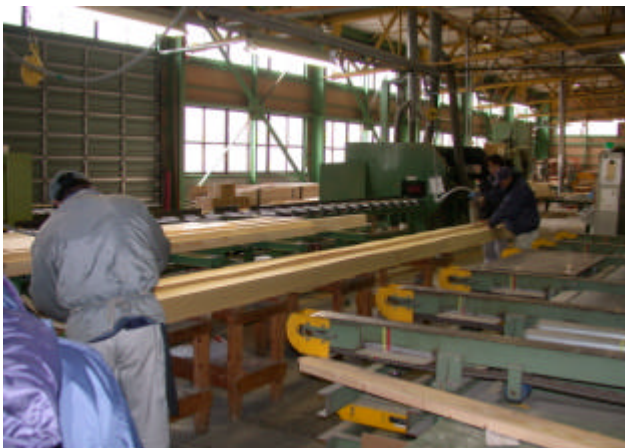
化粧単板の接着現場
