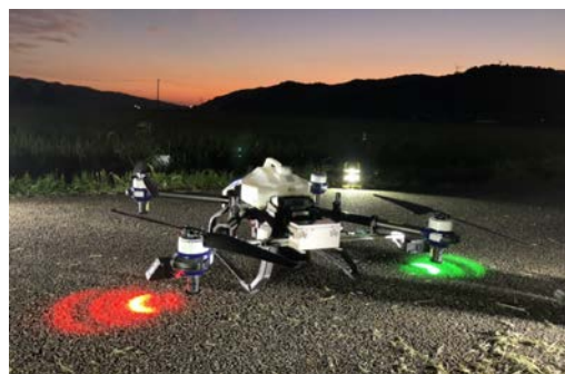
図 機体に LED ライトを設置
