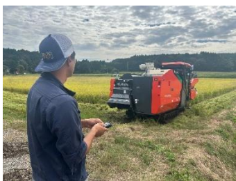
奥能登地域におけるロボットコンバインの検証
