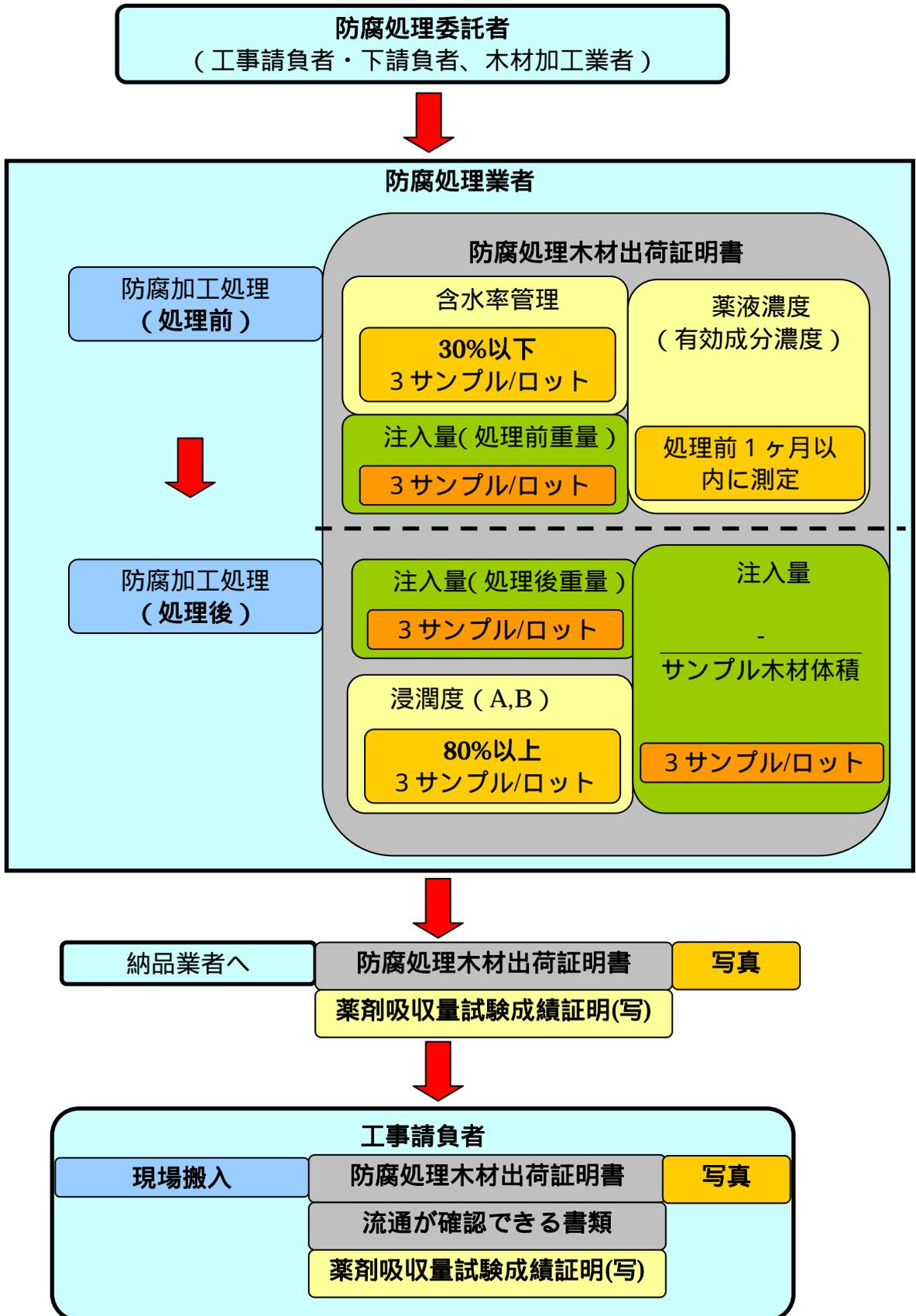
防腐処理木材品質管理確認に係るフロー図（現場～監督員）
