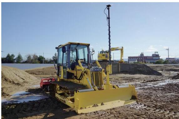
図1：農業用ブルドーザによるほ場均平作業
