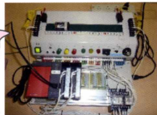
PLC (生産機械用コンピュータ)の実習装置
