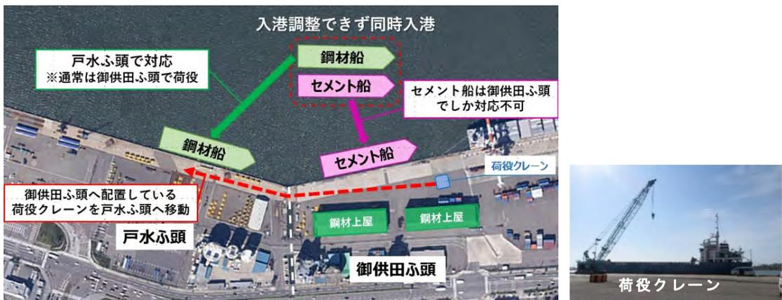
図 3-4 鋼材船とセメント船の同時入港時の荷卸しの調整
