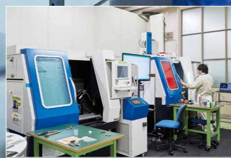
複数の金属3Dプリンターを備える環境を生かし、県内企業の試作や技術開発をサポートしています。
