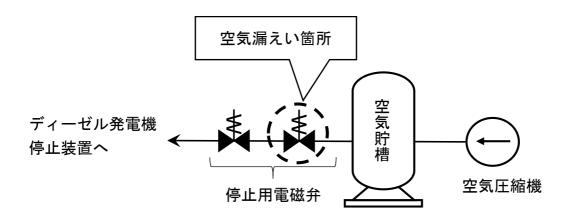
HPCS ディーゼル発電機始動停止用圧縮空気供給系統 概略図
