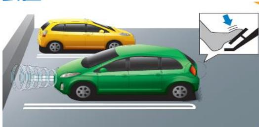
レーダー等で前方又は後方に障害物を検知した状態でアクセルを急激に踏み込んだ場合にエンジン出力を抑えることで、急加速を防止するもの
