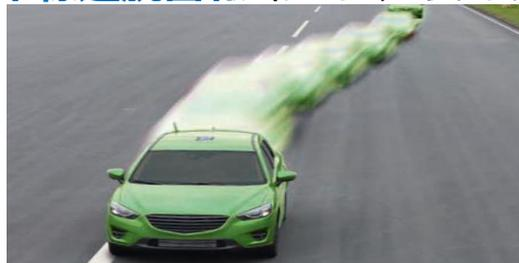
車載カメラにより車線を検知し、車線逸脱のおそれがある場合に、運転者に警報するもの
