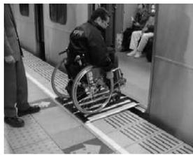
段差解消機（電動スロープ）
