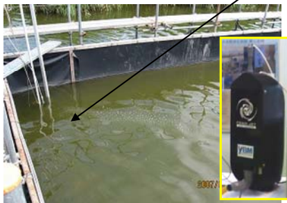
図4 溶解装置を設置した隔離水塊
