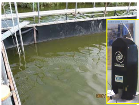
図3-4 溶解装置を設置した隔離水塊
