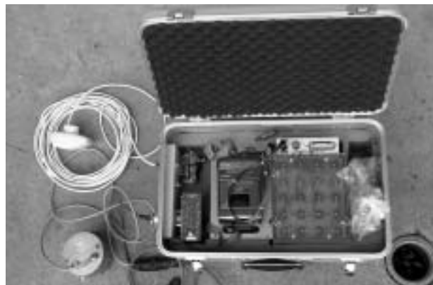
写真1 臨時地震観測点で用いたDATテープ式レコーダー(右)，地震計(左下)，GPSアンテナ(左上)
