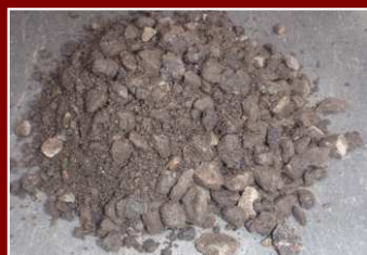
【破砕施設】 破砕処理⇒再生骨材の製造
