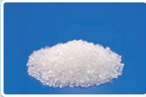
粉碎加工されたプラスチックは押出機に入れられ、ひも状の樹脂に加工されます。そして冷却バスを通りペレタイザーという機械に引込み、米粒状にカットされます。この米粒状の樹脂がいわゆるペレットといわれるものです。
