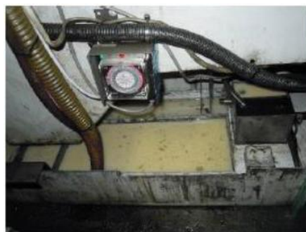
切削油の不純物を除去して延命化することによりリデュース
