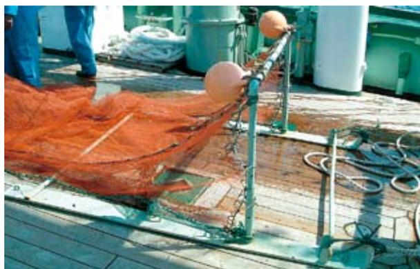
写真 調査用に試作したソリ付き桁網
