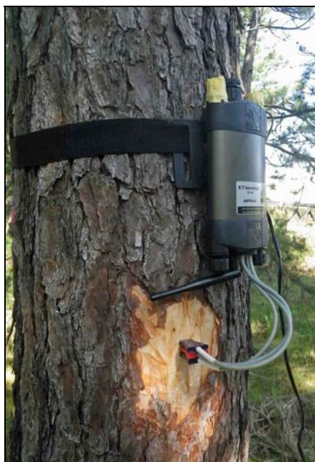
図-1 樹液流速機器（SFM1）の設置図
