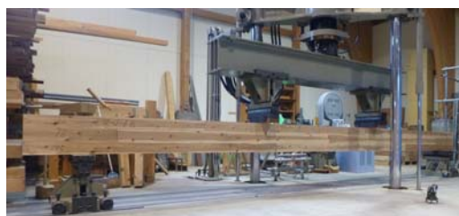
写真1 接着重ね梁の曲げ強度試験風景
