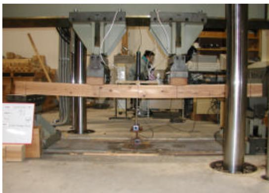
乾燥材の曲げ強度試験
