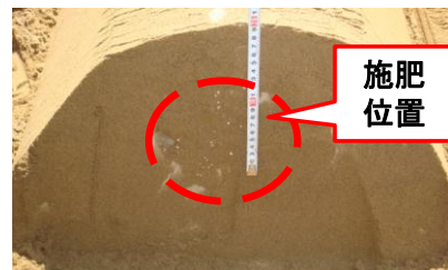
図 1 うね内部分施肥機により成形したうねの断面
