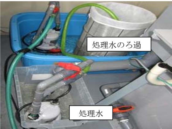
図10 処理水ろ過装置
