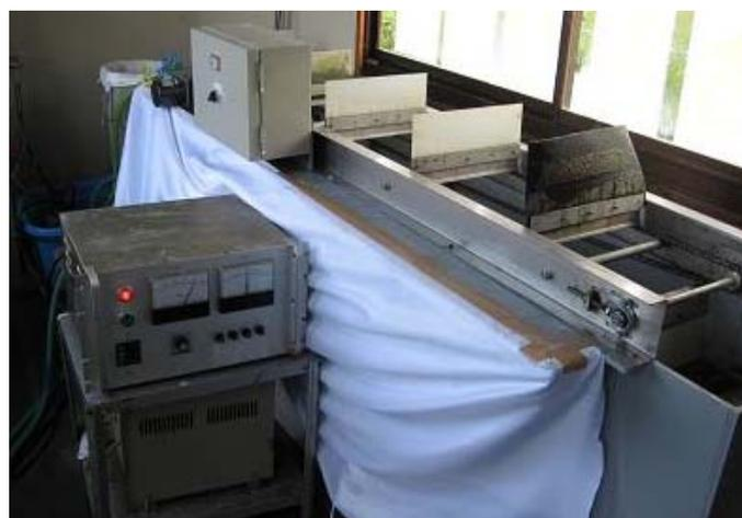
図5 電気分解装置
