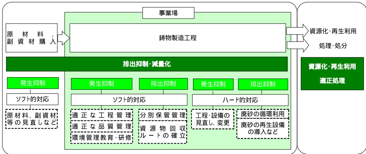
図 1-2 鋳さいの排出抑制・減量化の概要図
